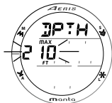
Fig. 42 - SET DEPTH ALARM
