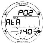
Fig. 46 - SET PO2 ALARM
